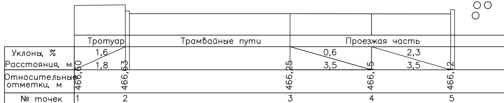
Поперечный профиль проезжей части и тротуаров (опора №3)
